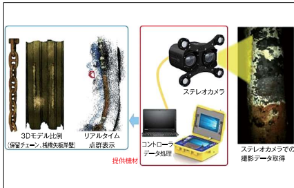
HYDRO300での水中構造物点検・計測
