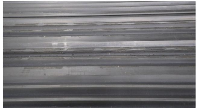
写真7 止水ゴム裏面(局部拡大)
