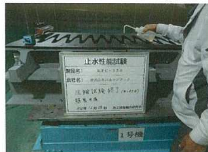
圧縮試験数量時簡易水張り 漏水なし
