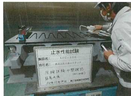
中間簡易水張り 漏水なし
