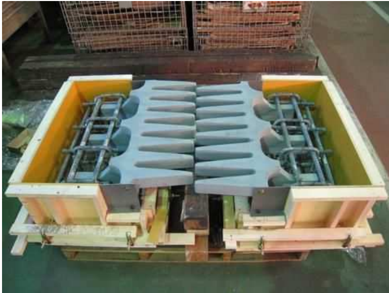
試験体① (コンクリート充填前)
