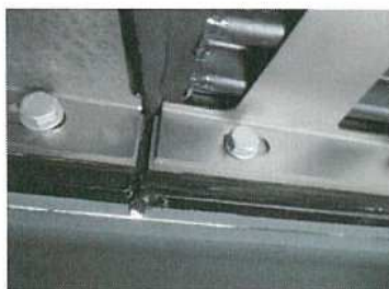
水張り試験終了（漏水なし）
