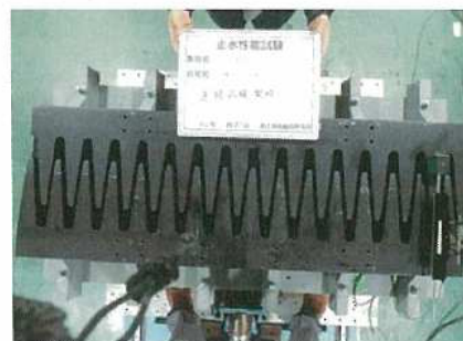
連続試験圧縮時（+93.750mm）
