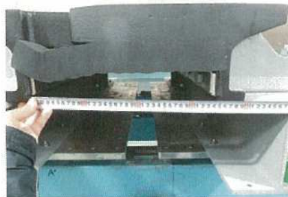
連続試験圧縮時（+93.750mm）
