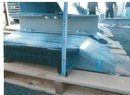
供試体寸法確認（側面）
