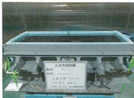
水張り試験終了（漏水なし）
