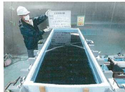
水張り試験終了（漏水なし）
