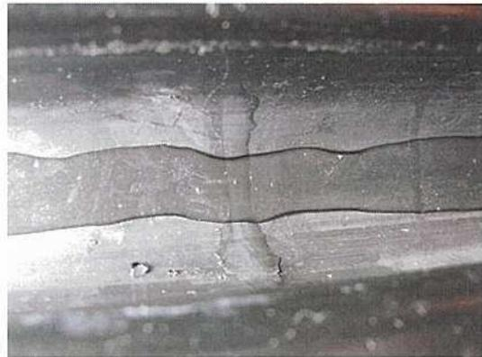
連続試験終了時の簡易水張り状況（漏水なし）
