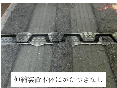
写真 5: 試験後の伸縮装置本体
