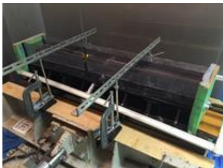
写真 7: 水張試験状況（全体）
