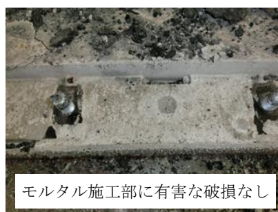
写真 6: 試験後のブラケット付近
